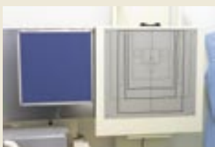
左の青色の四角い板の中にX線フィルムが納められている。フィルムなので当然ながら現像という作業が必要であり、クリニックには暗室も用意されている。フィルムの部分をOCDなどのセンサに交換することによって、デジタル化することが可能で、現在の装置はそのまま使用できる。
